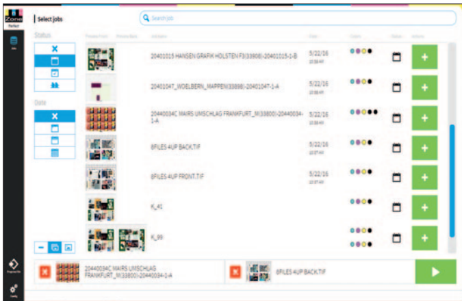
Jobs aus jedem Workflow treffen via DI-Plot in InkZone Perfect ein und werden mit Drag & Drop auf die Druckmaschine geladen.
