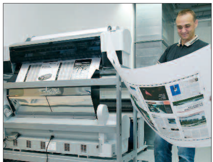
Der Preproofer produziert beidseitig bedruckte Formproofs ohne Wendeeinheit. Das macht ihn für Urs Staudacher auch konzeptionell zur überzeugendsten Lösung.
