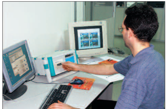
Die InkZone-Box (Bildmitte) schreibt die Farbzonens-Preset-Daten in allen Formaten der bekannten Druckmaschinen auf die entsprechenden Datenträger. Links im Bild die Benutzeroberfläche der Formproof-Software DI-Plot, der Bildschirm rechts zeigt eine Vorschau der ausgeschossenen Druckform.
